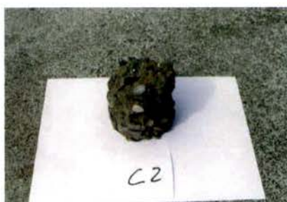
Éprouvette au bout de 80 cycles de l'essai d'écaillage
