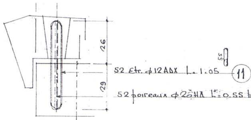
Détail du liaisonnement corniche / structure
