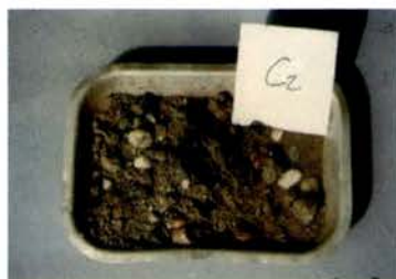
Éprouvette au bout de 116 cycles de l'essai d'écaillage
