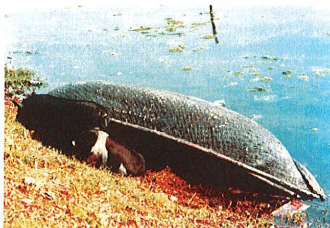
Figure 1. Embarcation vietnamienne (cloracle) enduite d'un produit bitumineux
