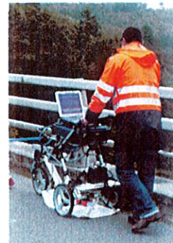
d) Antenne posée (ou de contact) sur chariot
