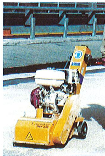
Figure 103. Microraboteuse permettant d'écrêter un support béton trop rugueux
