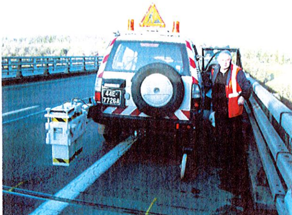
Figure 64. Antenne portée sur véhicule
