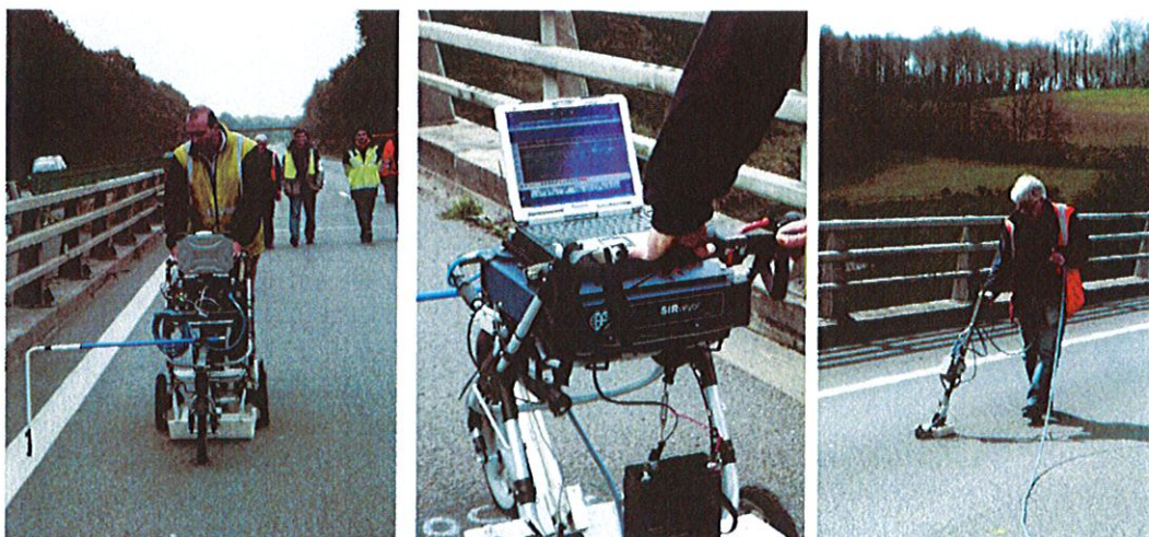
a) Antenne sur chariot/poussette avec roue codée et tige de positionnement latérale
