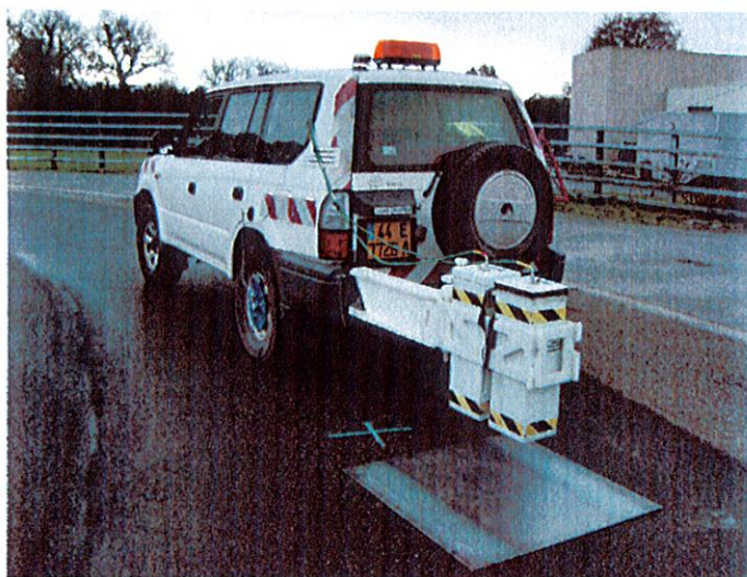
Figure 138. Étalonnage d'antennes portées (fréquence centrale de 2 GHz) sur une plaque métallique
