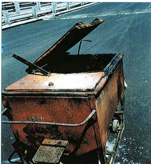
Fondoir à bitume polymère pour traitements localisés (par exemple arrêts de couche de reprofilage / support de chape)
