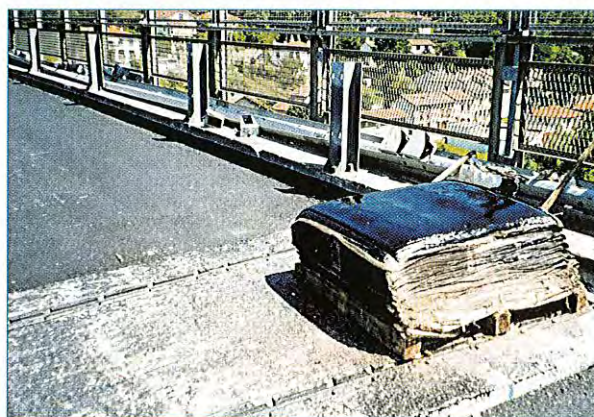
Liant bitume-polymère pour traitements localisés (livré en feuilles qui seront fondues)
