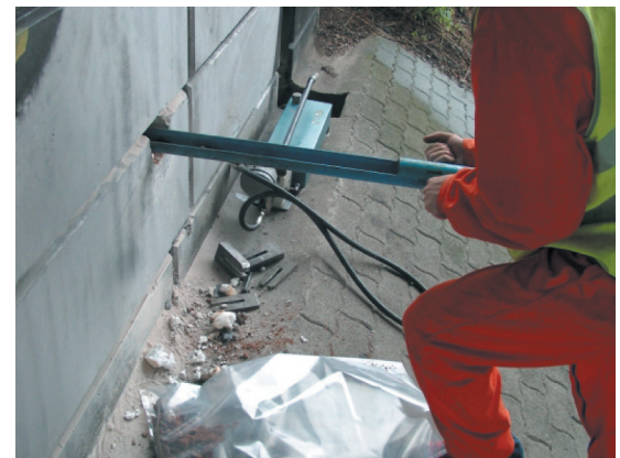
Photo 20. Extraction de remblai avec tube de prélèvement
