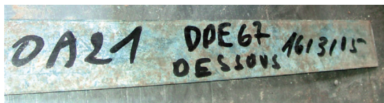
Photo 4. Armature métallique lisse en bande (photo CETE de l'EST)
