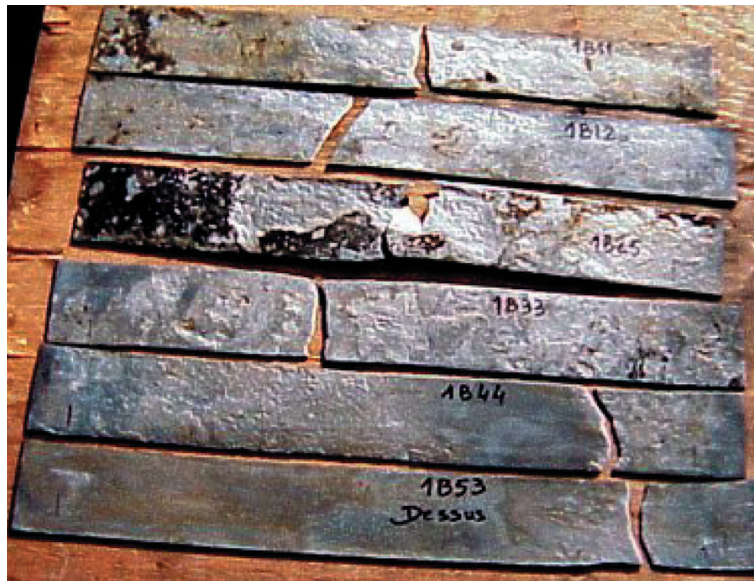
Photo 32. Armatures après réalisation de l'essai de traction
