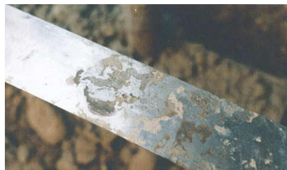
Photos des fouilles et détails de la corrosion des armatures
