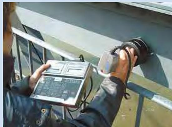
L'écart colorimétrique  $\Delta E_{ab}$  permet de suivre l'évolution de la teinte du revêtement. Pour les couleurs du nuancier ACQPA, l'écart colorimétrique acceptable est donné dans la norme NFT 34.554 – 1.
