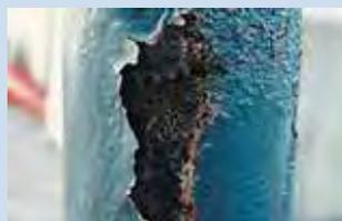
Figure 3.4 – Enrouillement sous-jacent
