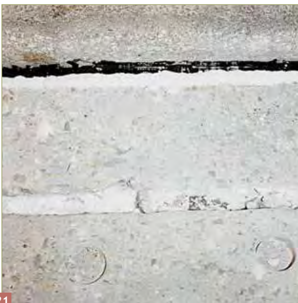
Essais d'arrachement sur le béton support.
