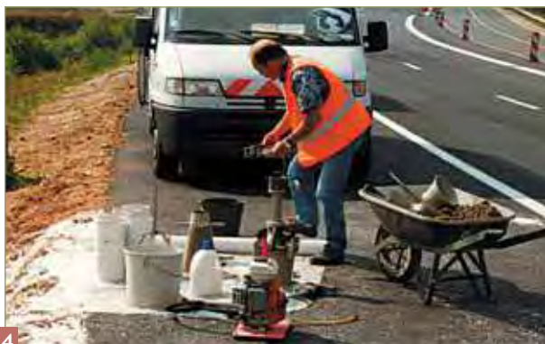
Réception du béton : confection d'éprouvettes et mesure de la teneur en air occlus.
