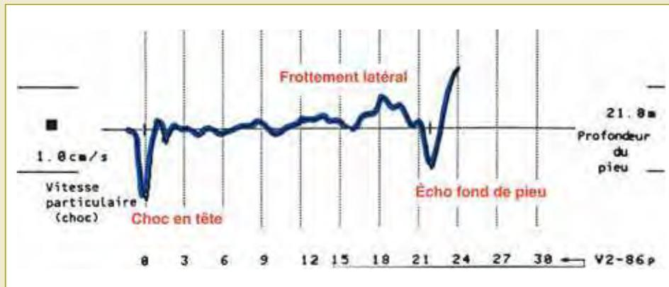
▲ Figure 12 - Analyse de la courbe obtenue par réflexion.
