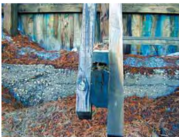
Figure 64 - Rupture par excès de traction transversale.
