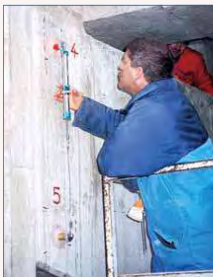
Mesure de distancemétrie à l'aide d'un fil Invar.
