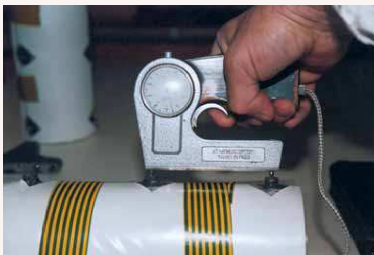
Mesure au pfender sur éprouvette soumise à l'essai d'expansion.
