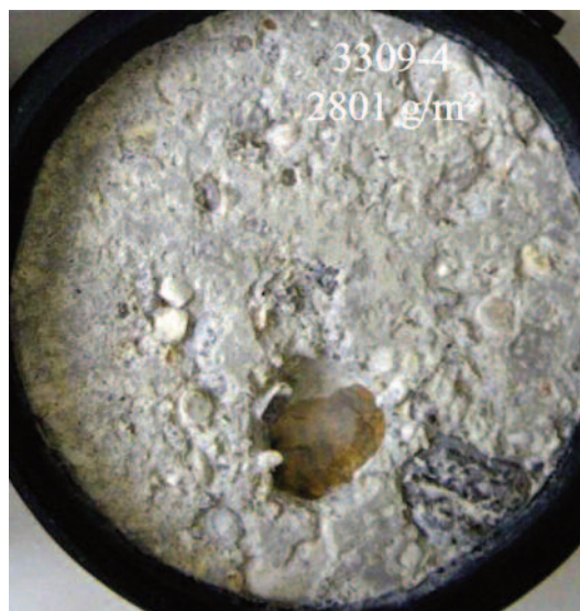
Figure 13 – Poursuite de l'essai d'écaillage jusqu'à 302 cycles afin de mettre en évidence le biais généré par la détérioration d'un granulat proche de la surface (Bouteille, 2013)
