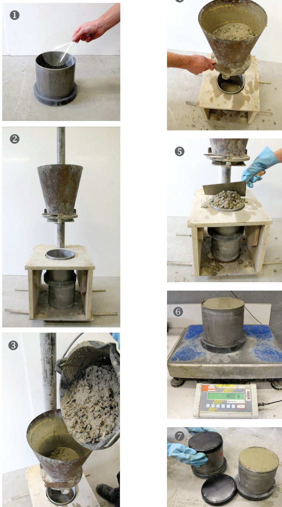
Figure 10 Différentes étapes du coulage des éprouvettes
