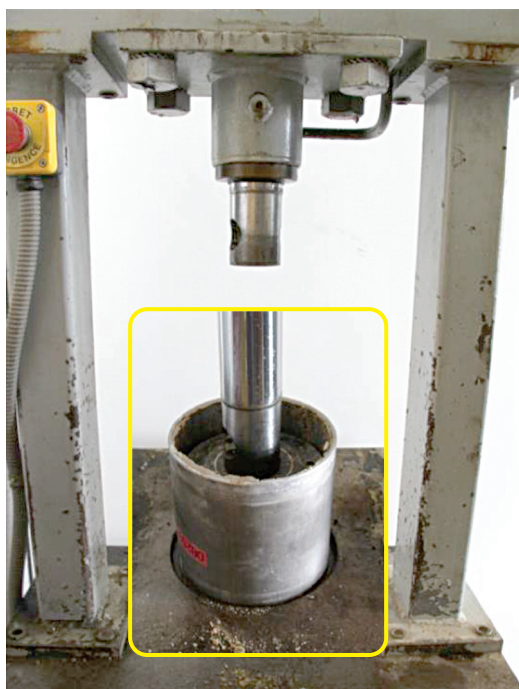
Figure 13 Démoulage des moules à l'aide d'une presse
