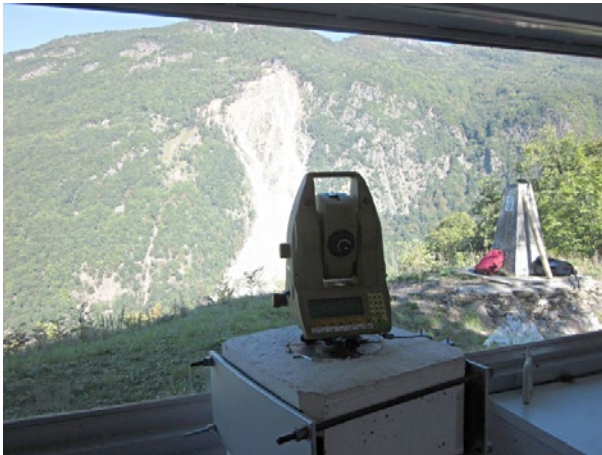
Figure Cas9.3 Station de mesures automatisée
